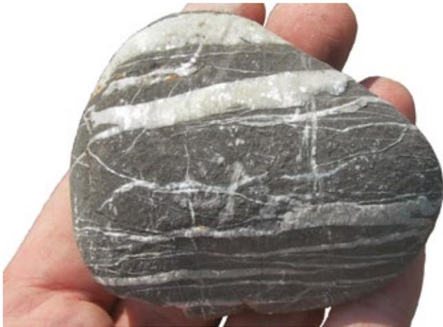
**Fig. 23** - Calcare nero con fessure riempite di calcite.
